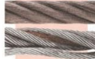
Aşırı Gerilim Uygulanması Sonucu Damarın Ayrılması
