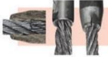
Baskı Sonucu Halatın Zedelenmesi
