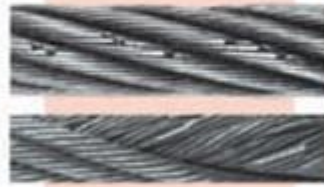
Halatın Geniş/Dar yiv ve Makara Üzerinde Çalışmasından Dolayı Hasarlanması
